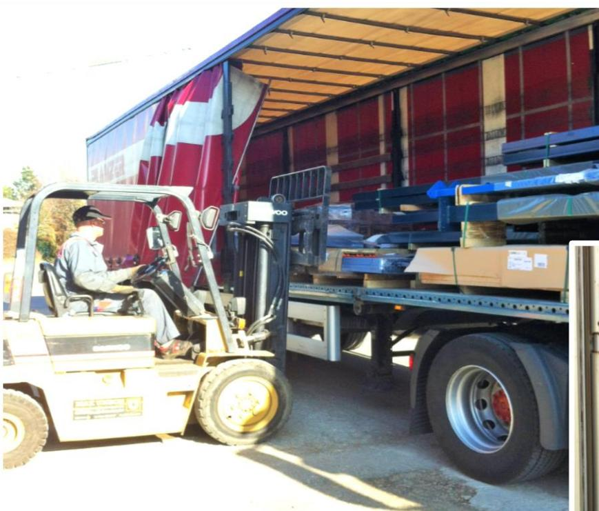
Selon les cas, le déchargement est réalisé au moyen d'un élévateur à contrepoids, d'une ridelle hydraulique, d'un transpalette etc.
