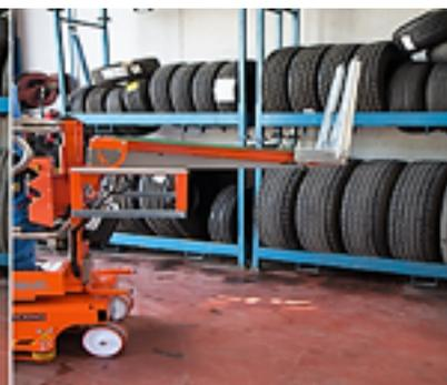
Option d'inclinaison de la plateforme pour pneus avec réglage de position de fourche
