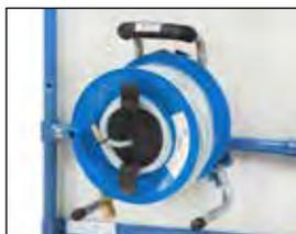
**Enrouleur de tuyau à air comprimé**
