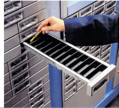
L'ouverture du tiroir est définie par la quantité demandée par l'opérateur
