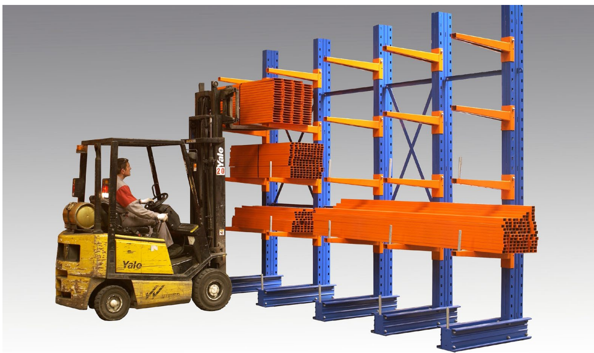
Chargement sur bras
