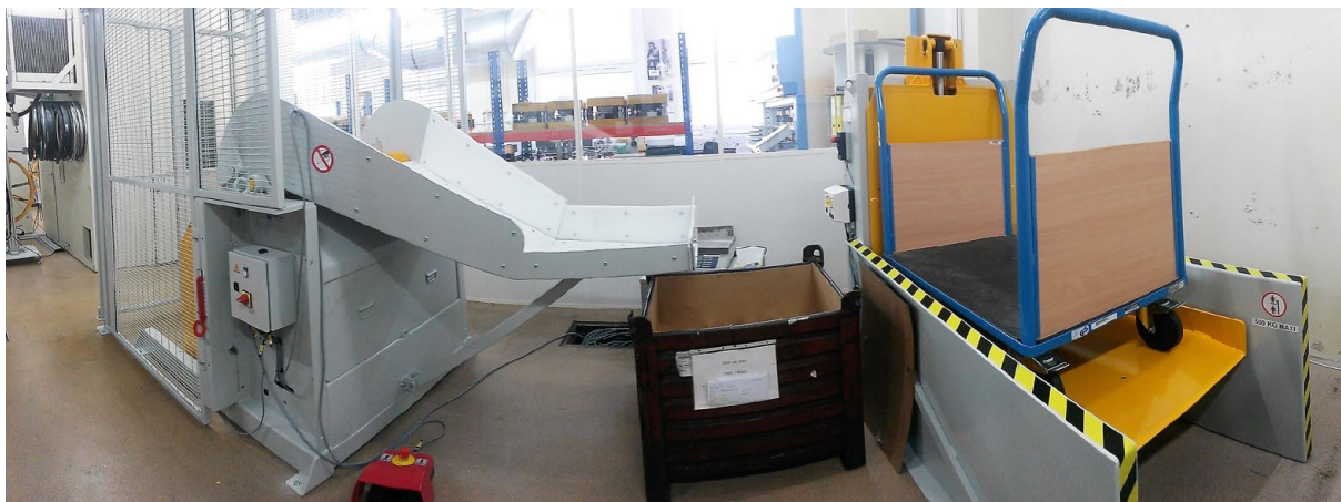
Retourneur de container et lève-chariot pour mise à hauteur ergonomique
