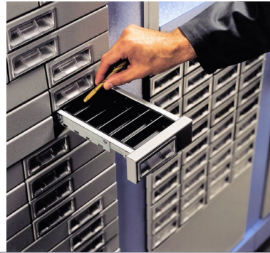
L'ouverture du tiroir est définie par la quantité demandée par l'opérateur
